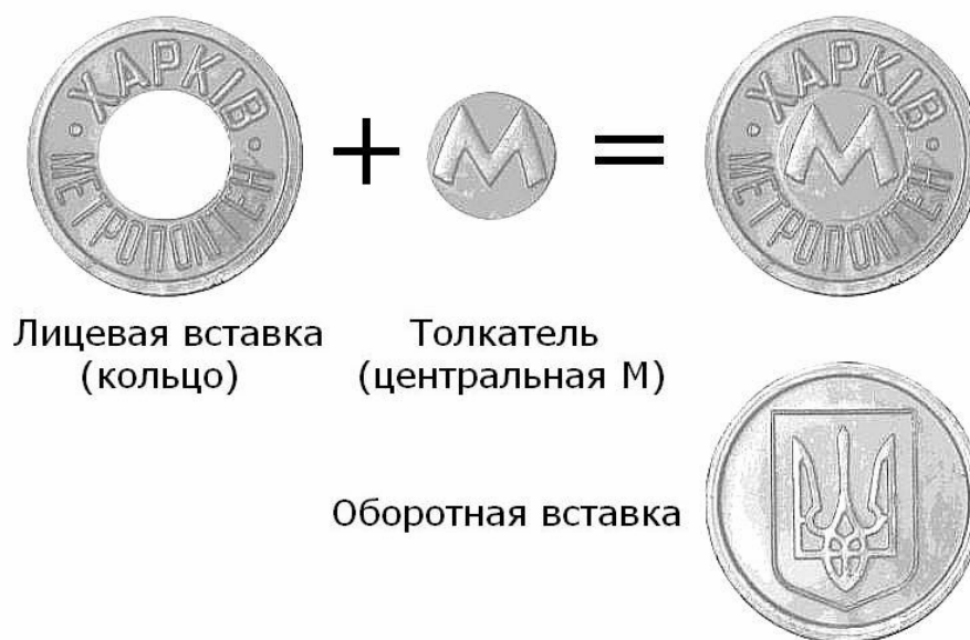
Илл. 1. Компоненты формы для отливки жетона
